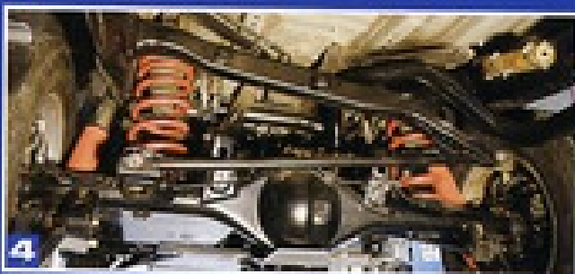
1 Le KDJ "Fruit de la passion" repose sur un ensemble ressorts / amortisseurs Proflex. 2 Les bonbonnes des amortisseurs avant sont fixées sur les passages de roue. 3 et 5 Les nouveaux combinés avant et les ressorts arrière augmentent la hauteur de caisse de 7 cm. 4 Les mécaniciens de Toyota Compétition ont fixé les bonbonnes d'amortisseurs arrière sur les longerons de châssis.
