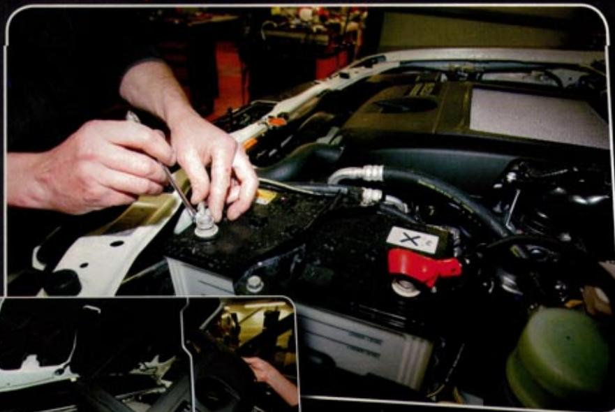
**1/** Première précaution d'usage, débrancher la batterie pour que le boîtier ne puisse être alimenté de manière inopinée et que cela cause un court-circuit.
