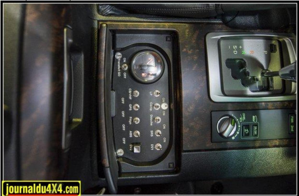
le porte gobelet a été remplacé par une [console](#) qui reprend les interrupteurs pour les différents accessoires. Pilote et copilote ne sont surtout pas oubliés car ils vont pouvoir bénéficier de très confortables **sièges baquets SPARCO** montés sur des **embases N4** et équipés de harnais Sabelt, on ne rigole pas avec
