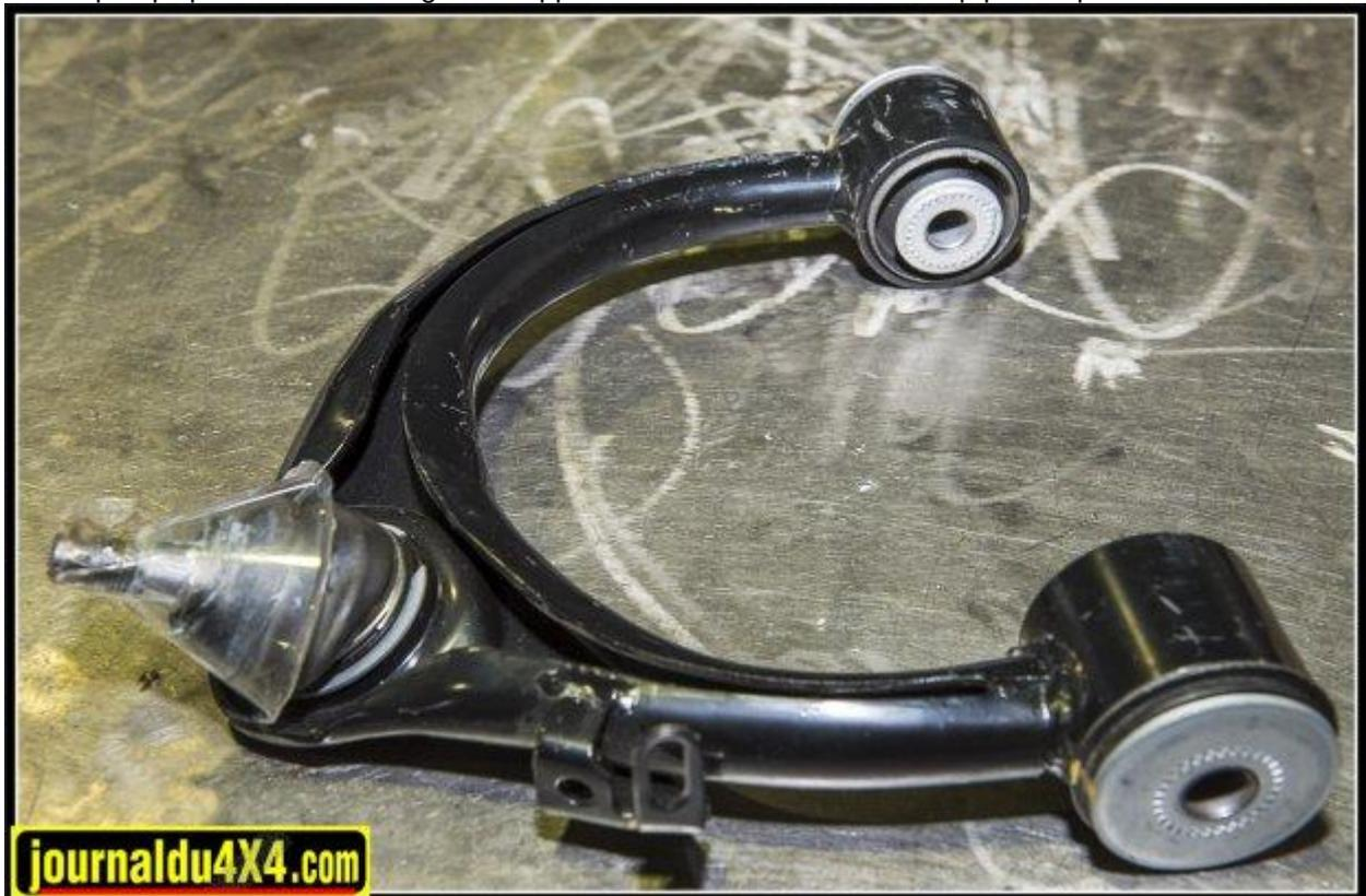
un triangle d'origine, ça comparer avec la version renforcée qui est montée sur ce VDJ 200
