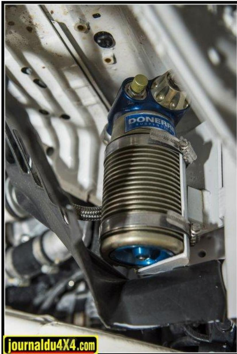
Les amortisseurs Donerre ont intégré dans le corps de l'amortisseur deux butées hydrauliques ou bumpstop qui ont pour rôle d'éviter les chocs en compression ou en détente maximum. Ces sortes d'amortisseurs supplémentaire amortissent la fin de course et protègent efficacement l'intégrité des amortisseurs et du châssis.
