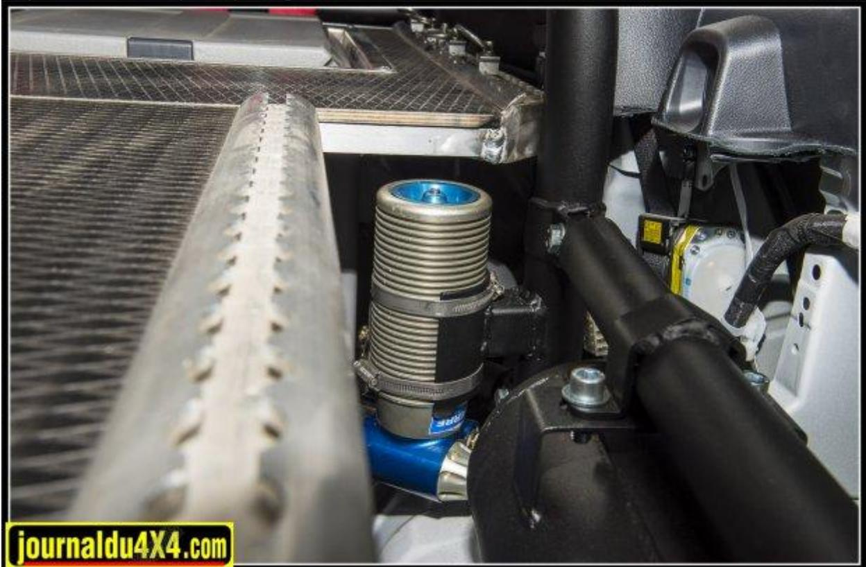
les amortisseurs arrière passent dans le coffre grâce à un passage ménagé dans la caisse. La tête d'amortisseur et la bonbonne restent accessibles pour peaufiner les réglages de la suspension
