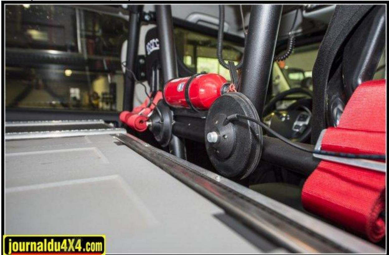
sur l'arceau les embases magnétiques des antennes attendent sagement avant d'être positionnées sur la carrosserie quand l'engin sera en raid
