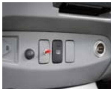
L'interrupteur du boîtier Adonis permet de le déconnecter facilement
